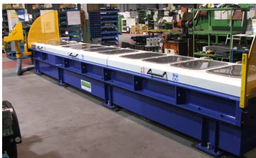
Coperture (Banco da 80 Ton)
